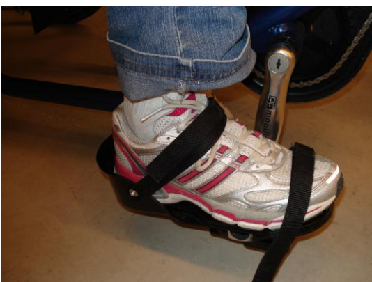
Kuva 16. Apukuljettajan polkimissa on levennetyt polkimet, sekä mahdollisuus kiinnittää jalkaterä tarroilla polkimeen.
