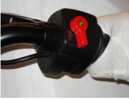
Kuva 7. Kun tarvitset avuksi moottoria, käännä kuljettajan ohjaustangossa oik. olevaa punaista katkaisijaa asennosta OFF asentoon ON.
