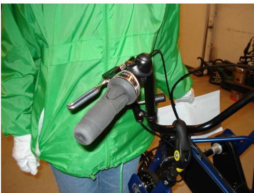
Kuva 11. Vaihteet sijaitsevat kuljettajan puolen ohjaustangossa vas. puolella. Vaihteet vaihtuvat käsikahvan soittokellon päädyn puolelta kiertämällä.
