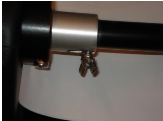
Kuva 14. ja 15. Apukuljettajan polkimien vapauttaminen/lukitseminen tapahtuu siirtämällä säätöhylsyä oikealle tai vasemmalle. Jolloin mustassa osassa oleva tappi osuu säätöhylsyn koloon.
