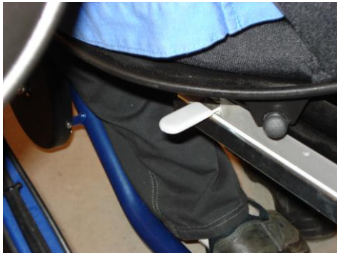
Kuva 4. ja 5. Istuimen säätö tapahtuu penkin sisemmän reunan alta. Nosta harmaata vipua ylöspäin kohti istuinosaa ja liu'uta samalla penkkiä eteen tai taakse.
