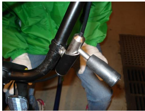
Kuva 8 ja 9.. Pysäköintijarru saadaan päälle ohjaustangon vas. puolella olevasta kääntötapista. Kääntötappi liu'utetaan siinä olevaan koloon.
