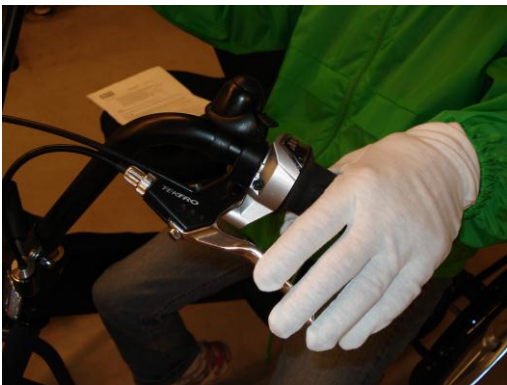
Kuva 10. Pyörässä on kuljettajan puolen ohjaustangossa käsijarrut: vas. kahvalla jarrutetaan etupyörää, oik. takapyörää.
