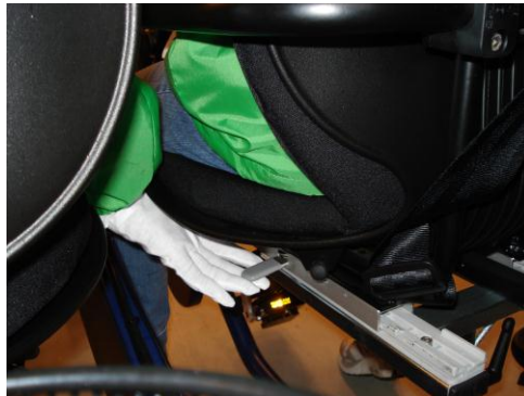
Kuva 4. ja 5. Istuimen säätö tapahtuu penkin sisemmän reunan alta. Nosta harmaata vipua ylöspäin kohti istuinosaa ja liu'uta samalla penkkiä eteen tai taakse.
