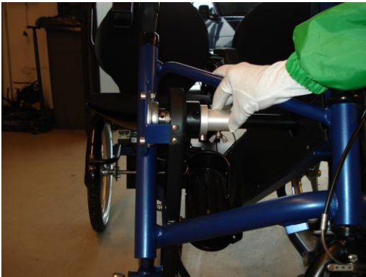
Kuva 14. ja 15. Apukuljettajan polkimien vapauttaminen/lukitseminen tapahtuu siirtämällä säätöhylsyä oikealle tai vasemmalle. Jolloin mustassa osassa oleva tappi osuu säätöhylsyn koloon.
