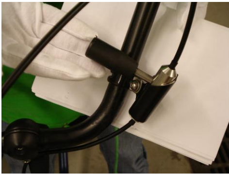
Kuva 8 ja 9.. Pysäköintijarru saadaan päälle ohjaustangon vas. puolella olevasta kääntötapista. Kääntötappi liu'utetaan siinä olevaan koloon.
