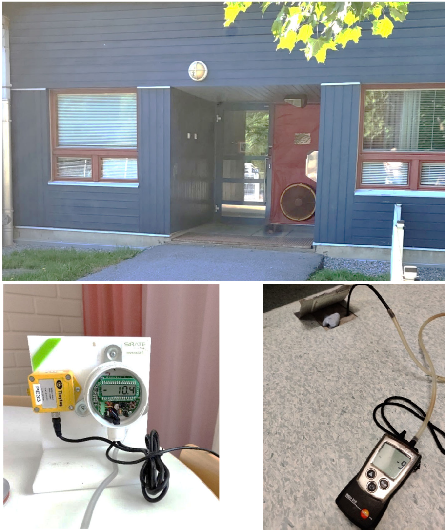
Kuva 3. Tilat alipaineistettiin merkkiainetutkimusten ajaksi n. -10 Pa ulkoilmaan sekä alapohjatilaan nähden.
