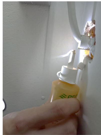
Kuva 5.10. Tilan 2118 ulkoseinässä on pihavalaisin (vasen kuva). Valaisimen sähköjohdon läpivienti sisätiloihin ei ole tiivis, mikä on havaittavissa merkkisavulla (oikea kuva).
