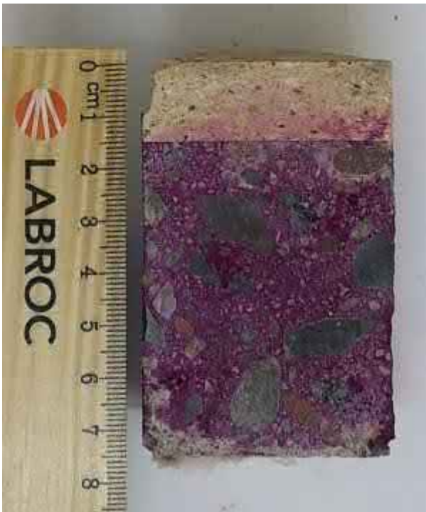
Näytelieriön halkaistu pinta, ulkopinta kuvassa ylöspäin
