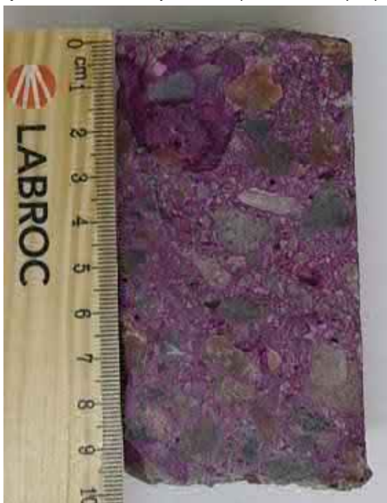
Näytelierrion halkaistu pinta, ulkopinta kuvassa ylöspäin
