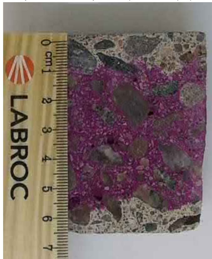
Näytelieriön halkaistu pinta, ulkopinta kuvassa ylöspäin
