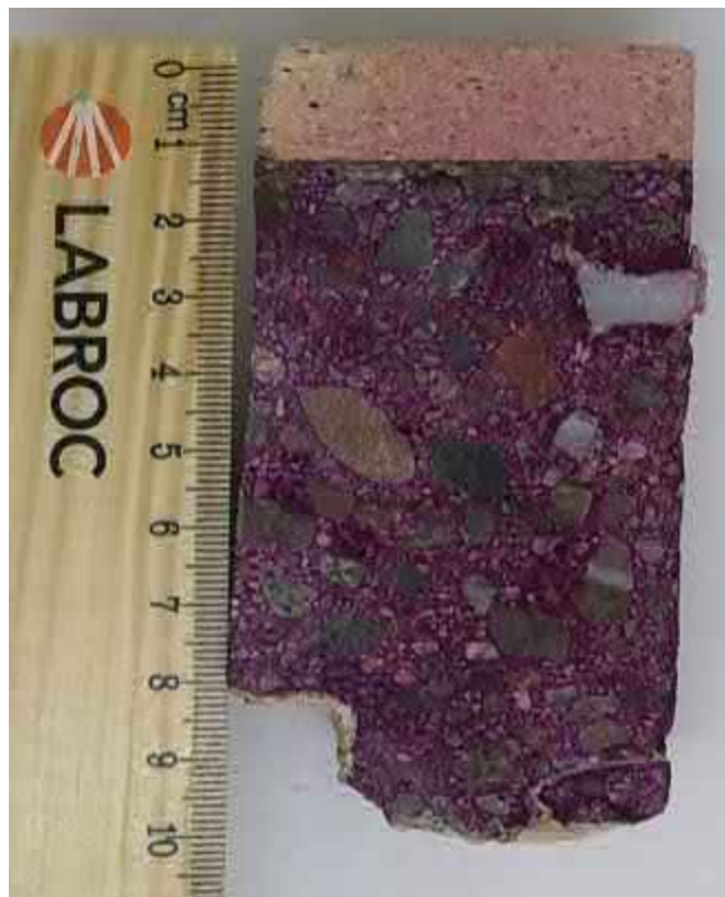
Näytelieriön halkaistu pinta, ulkopinta kuvassa ylöspäin
