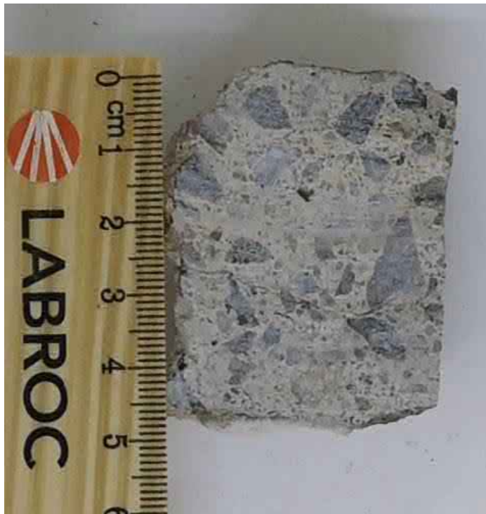
Näytelieriön halkaistu pinta, ulkopinta kuvassa ylöspäin
