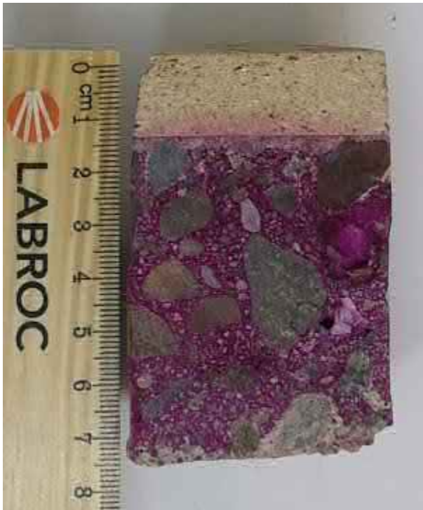
Näytelieriön halkaistu pinta, ulkopinta kuvassa ylöspäin
