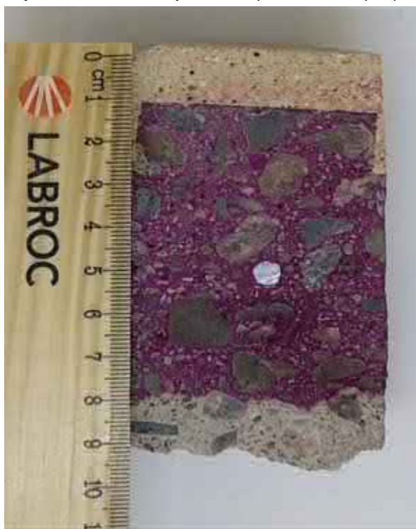
Näytelieriön halkaistu pinta, ulkopinta kuvassa ylöspäin
