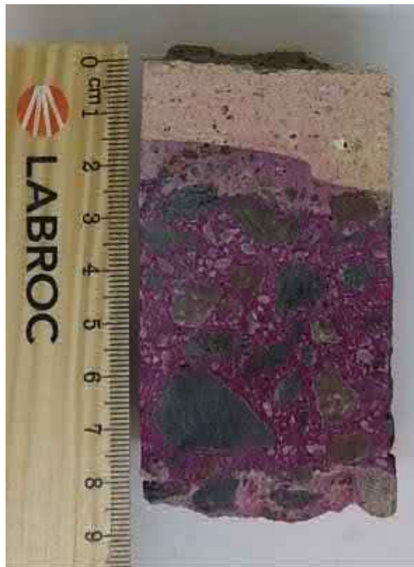
Näytelieriön halkaistu pinta, ulkopinta kuvassa ylöspäin
