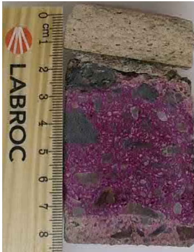
Näytelieriön halkaistu pinta, ulkopinta kuvassa ylöspäin
