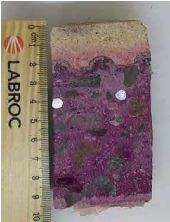
Näytelieriön halkaistu pinta, ulkopinta kuvassa ylöspäin
