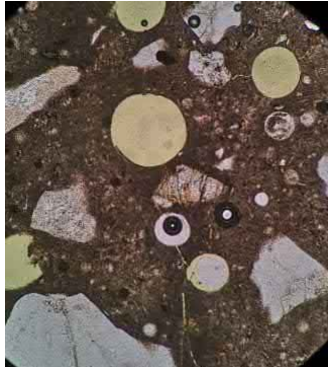
Ohuthiekuva, kuvan vaakasisivun pituus on 1,5 mm
