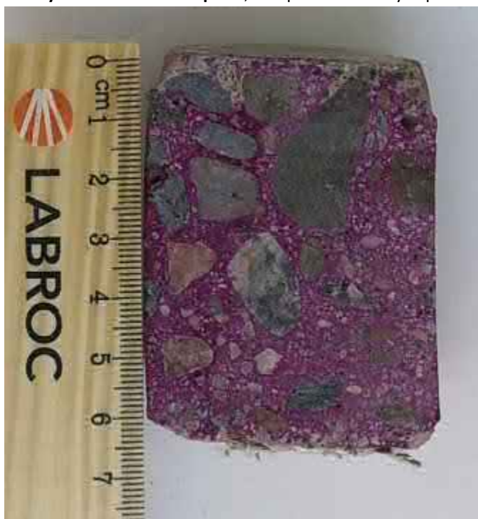
Näytelieriön halkaistu pinta, ulkopinta kuvassa ylöspäin
