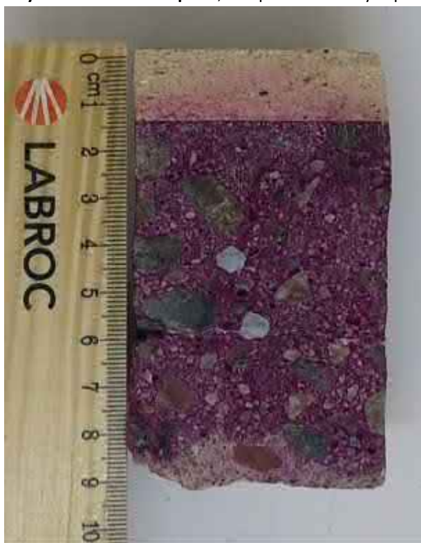
Näytelieriön halkaistu pinta, ulkopinta kuvassa ylöspäin
