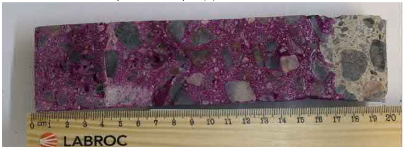
Näytelieriön halkaistu pinta, yläpinta kuvassa vasemmalla
