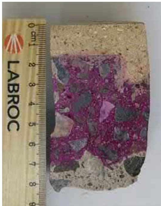
Näytelieriön halkaistu pinta, ulkopinta kuvassa ylöspäin
