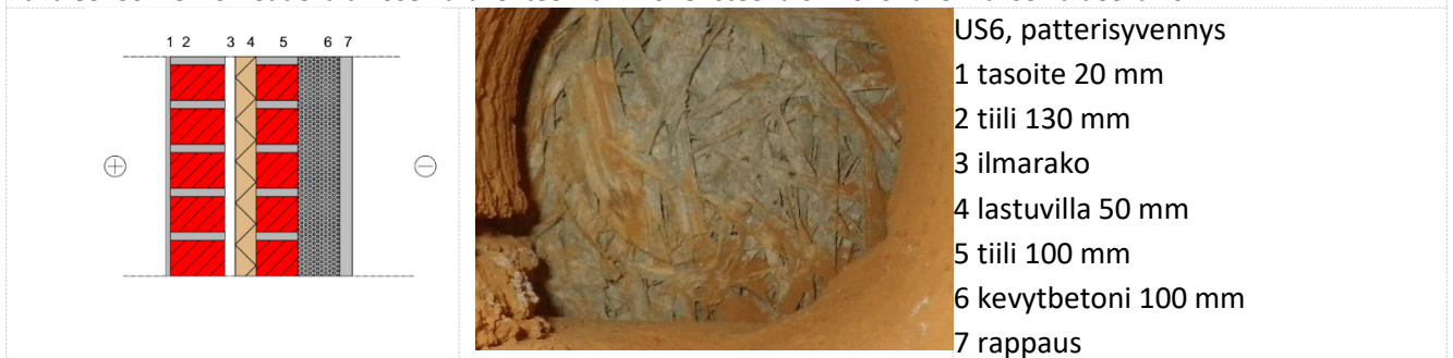
Kuva 84. Ulkoseinärakenne patterisyvennyksissä sokkelin yläpuolella.
