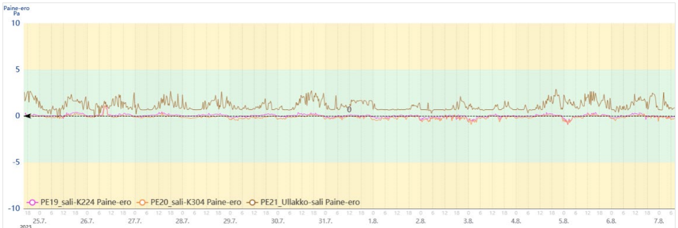
Kuva 112. Paine-ero konserttisalista viereisiin tiloihin ja ullakolle.
