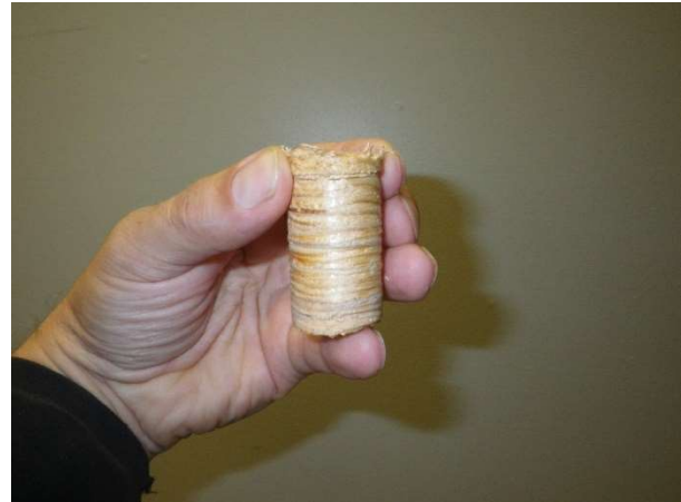
Kuva 20. Alaohjauspuusta irrotettu lieriö.
