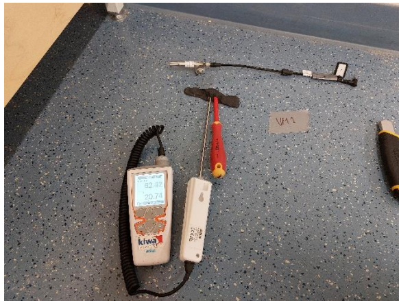
Kuva 19. Viiltokosteusmittaus VM1 muovimattopäällysteen alapinnalle.
