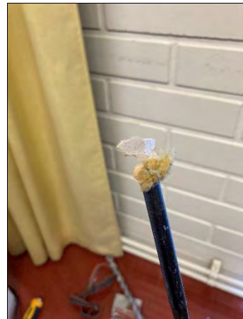
Kuva 57. Betonilaattojen välissä on kovavilla, josta otettiin näyte.
