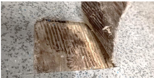
Kuva 26. Viiltomittauksessa V5 liima oli tummunut ja liimatilasta havaittiin mikrobiperäistä hajua.
