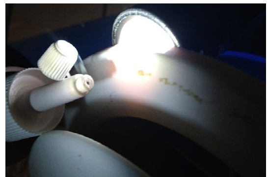
Kuva 1.4. Merkkisavulla todettiin korvausilmaa virtaavan putkiston kautta hyvin ryömintätilan eri osiin.
