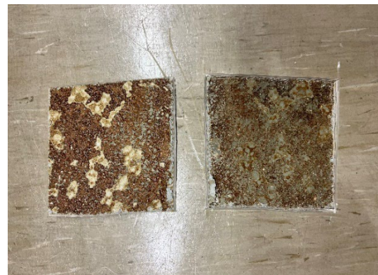
Kuva 2. Muovimatosta ja liimasta otettiin VOC-Bulk-materiaalinäyte
