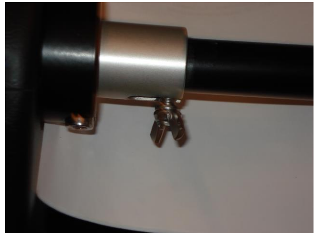
Kuva 14. ja 15. Apukuljettajan polkimien vapauttaminen ja lukitseminen tapah- tuu siirtämällä säätöhylsyä oikealle tai vasemmalle, jolloin mustassa osassa oleva tappi osuu säätöhylsyn koloon.
