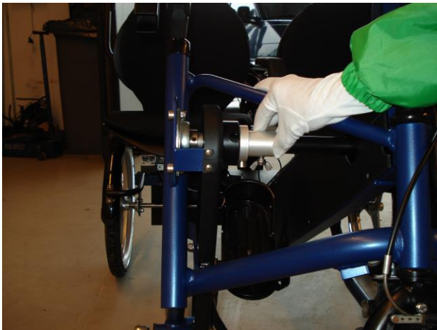
Kuva 14. ja 15. Apukuljettajan polkimien vapauttaminen ja lukitseminen tapah- tuu siirtämällä säätöhylsyä oikealle tai vasemmalle, jolloin mustassa osassa oleva tappi osuu säätöhylsyn koloon.
