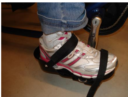
Kuva 16. Apukuljettajan polkimissa on levennetyt polkimet sekä mahdollisuus kiinnittää jalkaterä tarroilla polkimeen.
