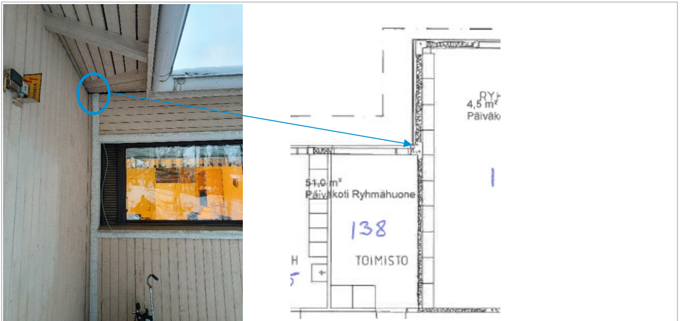
Kuva 19. Merkkiaineen laskupaikka yläpohjan ilmavuototutkimuksessa.
