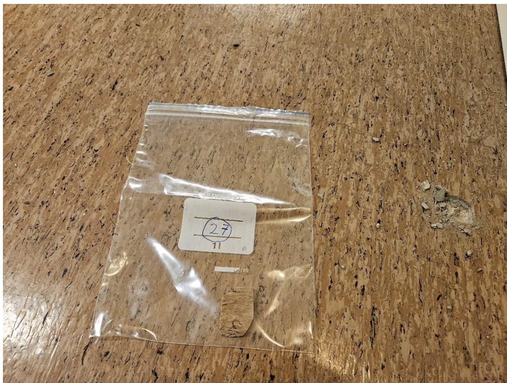
Kuva 37. Tummanruskea kirjava muovimatto + liima + tasoite ( näyte 27 ) eivät sisällä asbestia.
