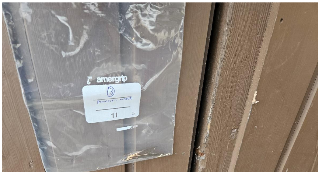
Kuva 20. Puisten ulko-ovien maalit ( näyte 3 ) eivät sisällä asbestia
