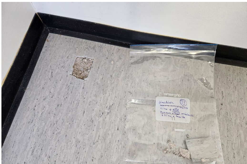
Kuva 1. Sinertävän harmaan muovimaton alla oleva tummanvihreä muovimatto (näyte 13) sisältää asbestia.
