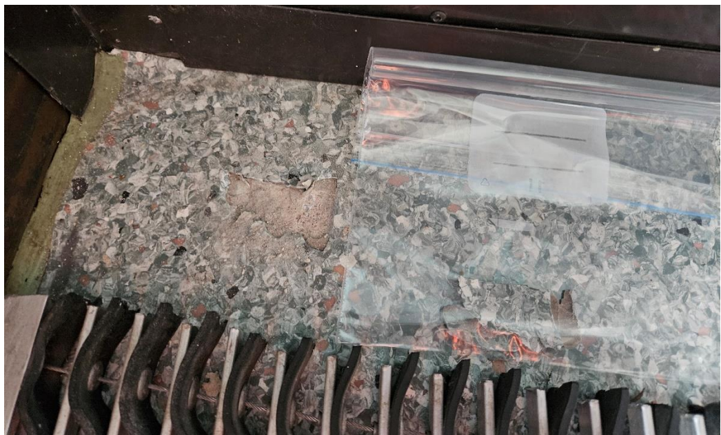
Kuva 34. Monivärinen muovimatto + liima + tasoite ( näyte 24 ) eivät sisällä asbestia.
