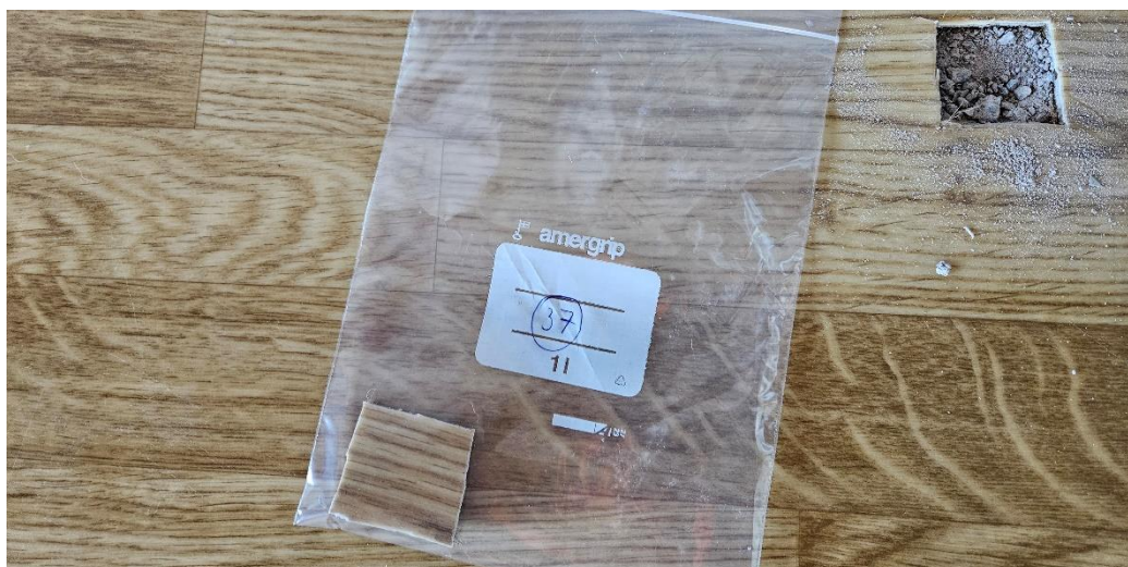
Kuva 44. Parkettikuvioitu muovimatto 2 + keltainen liima + harmaa karvalankamatto + liima + harmaa tasoite ( näyte 37 ) eivät sisällä asbestia.
