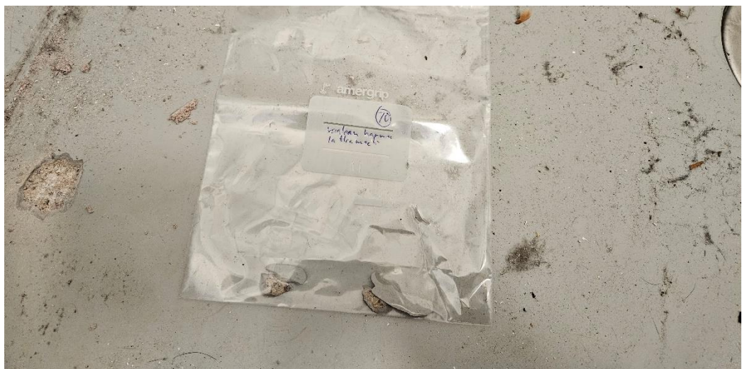
Kuva 27. Vaalean harmaa lattiamaali ( näyte 10 ) ei sisällä asbestia.
