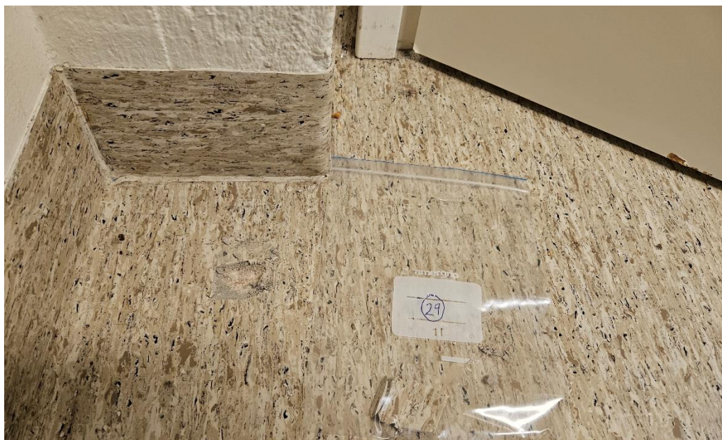
Kuva 39. Harmaa kirjava muovimatto + liima + tasoite ( näyte 29 ) eivät sisällä asbestia.
