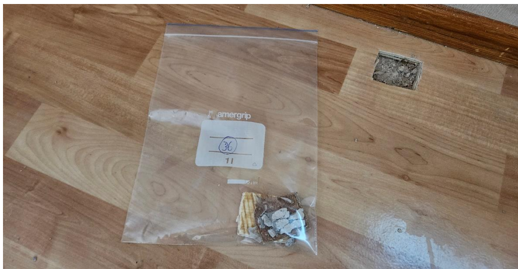
Kuva 43. Parkettikuvioitu muovimatto + keltainen liima, vaalea muovimatto + keltainen liima, harmaa karvalankamatto + liima, tasoite ( näyte 36 ) eivät sisällä asbestia.
