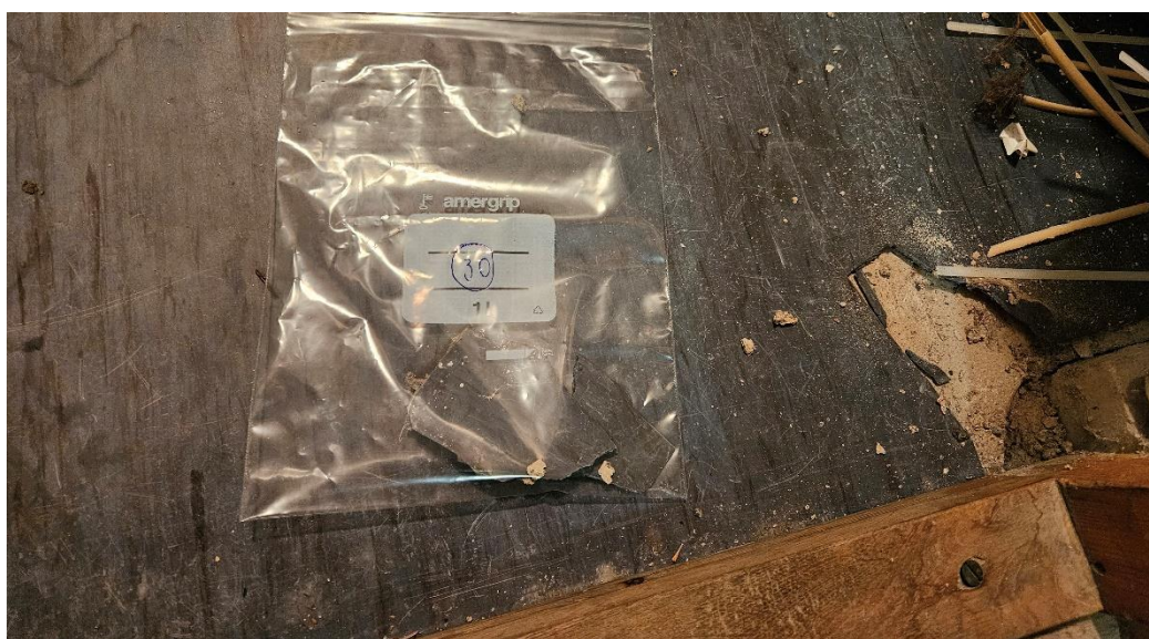
Kuva 40. Sininen muovimatto (ei liimaa) + harmaa tasoite ( näyte 30 ) eivät sisällä asbestia.
