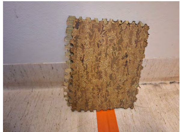
Kuva 42. AP5, kolmas muovimattokerros.
