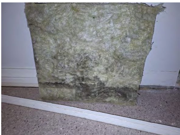
Kuva 85. US5, kipsilevyn takana olevassa mineraalivillan alaosassa ilmavirrasta johtuvaa tummentumaa.
