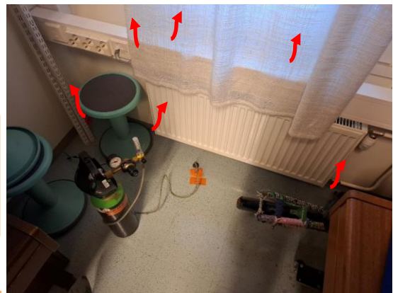
Kuvat 61 ja 62. Merkkiainekoe MA1 varastossa 22. Alapohjan eristetilaan syötettyä merkkiainekaasua havaittiin alapohja - ulkoseinäliittymässä, ikkuna - ulkoseinäliittymässä sekä sähkökotelon kiinnikkeen kiinnitysruuvien kohdalla.
