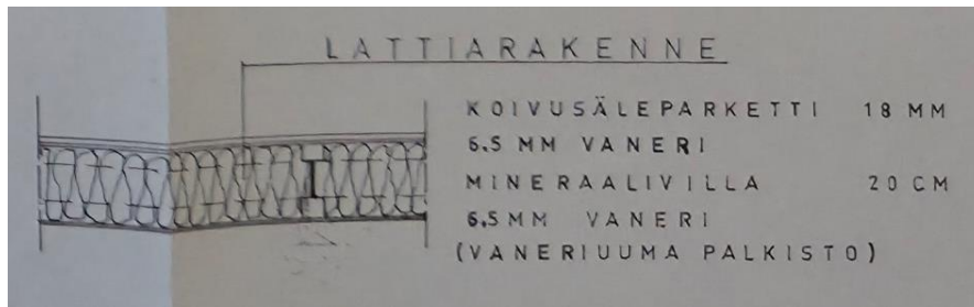
Kuva 24. Alkuperäisen osan alapohjan rakenteet vanhan juhlasalin kohdalla. Kuvassa osakuva piirustuksesta, Aunelan koulu, 4725, 22.1.1971.
