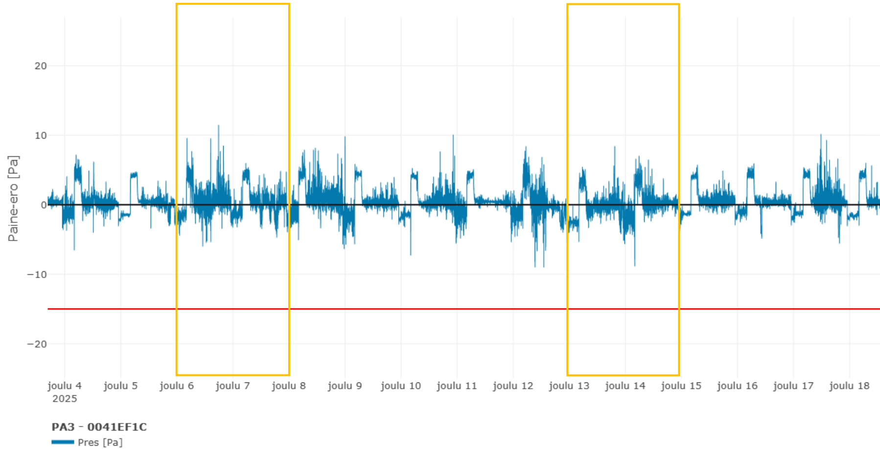
Kuva 3. Kuntosalin ja ulkoilman välinen paine-ero aikavälillä 3.–18.12.2025. Mustalla viivalla on merkitty paine-eron 0-taso ja punaisella Asumisterveysasetuksen toimenpideraja -15 Pa. Viikonloput on merkitty kuvaan oransseilla lokeroilla.
