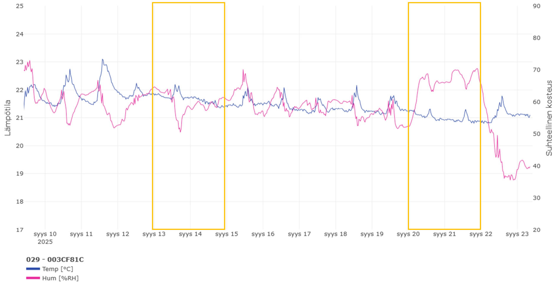
Kuva 12. Tilan 029 sisäilman lämpötila ja suhteellinen kosteus aikavälillä 9.9.–23.9.2025. Viikonloput on merkitty kuvaan oransseilla lokeroilla.
