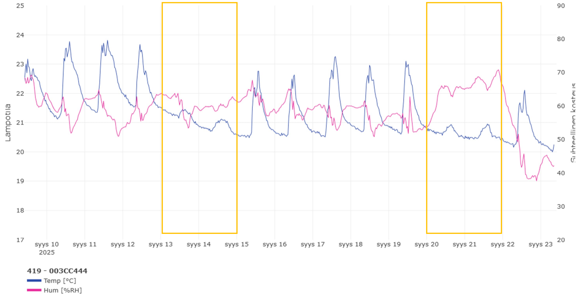
Kuva 20. Tilan 419 sisäilman lämpötila ja suhteellinen kosteus aikavälillä 9.9.–23.9.2025. Viikonloput on merkitty kuvaan oransseilla lokeroilla.
