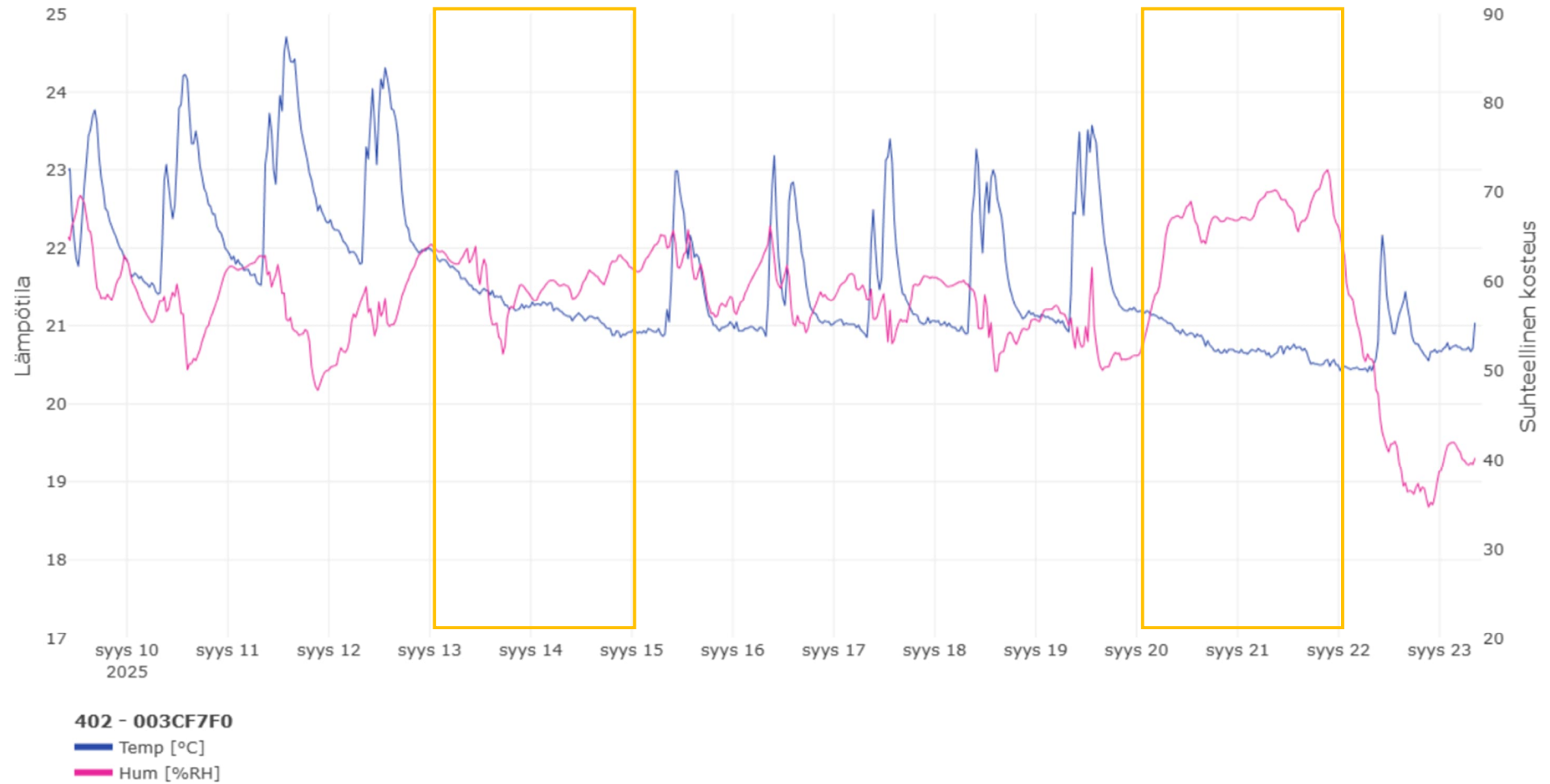
Kuva 19. Tilan 402 sisäilman lämpötila ja suhteellinen kosteus aikavälillä 9.9.–23.9.2025. Viikonloput on merkitty kuvaan oransseilla lokeroilla.
