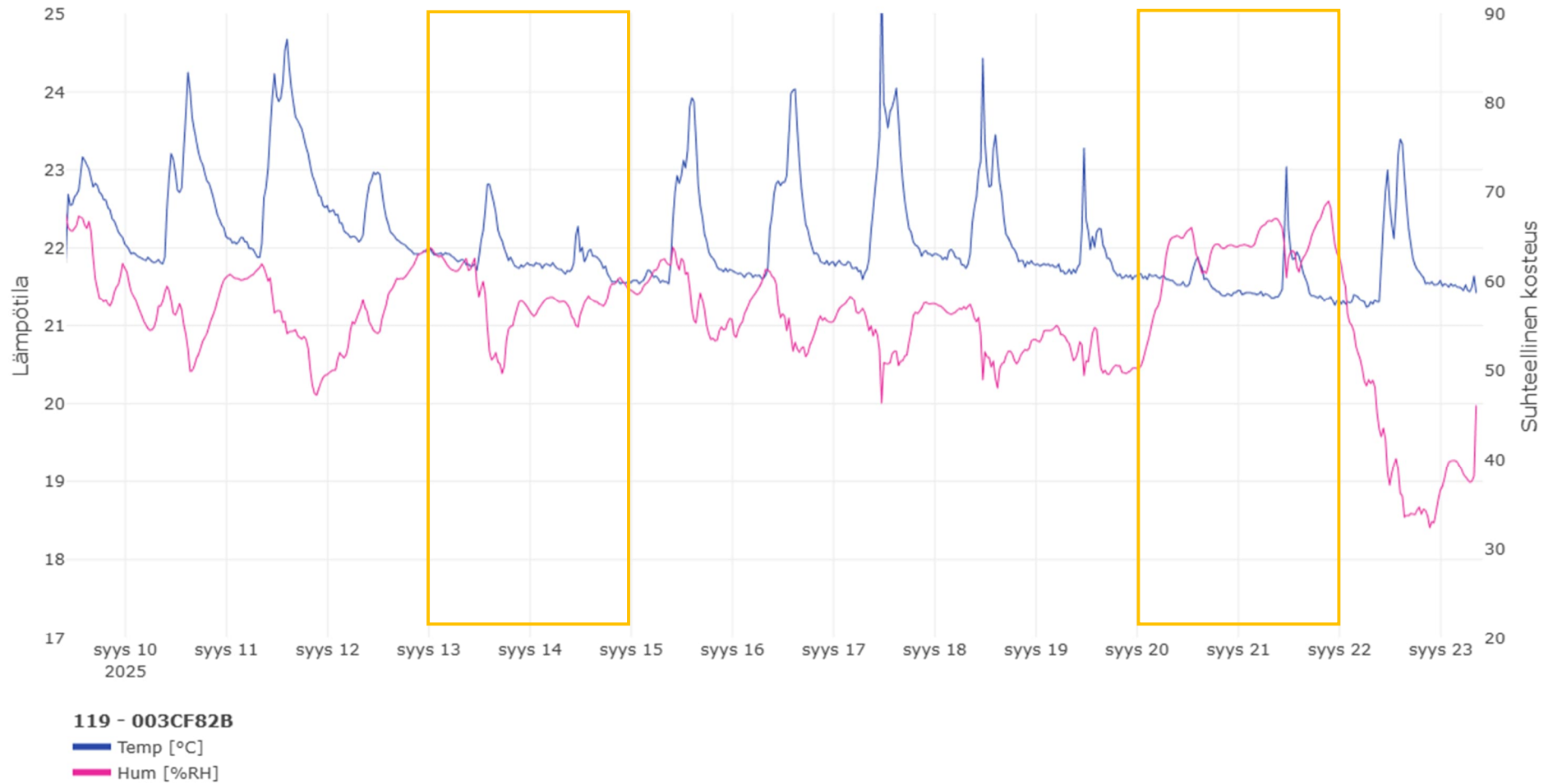
Kuva 14. Tilan 119 sisäilman lämpötila ja suhteellinen kosteus aikavälillä 9.9.–23.9.2025. Viikonloput on merkitty kuvaan oransseilla lokeroilla.
