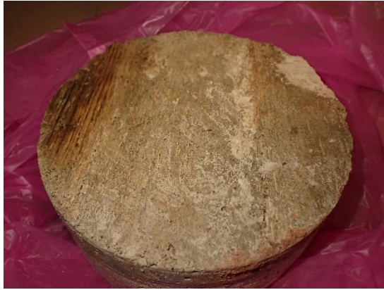
Kuvat 191 ja 192. Tilan 306 välikohdan avaus R43. Muottilaudoissa havaittiin lahoa, värimuutoksia ja rihmaa (ympyrä). Ylälaatan alapinnassa havaittiin myös mahdollista rihmaa, vasemmanpuoleinen kuva.
