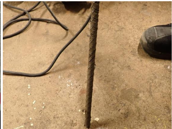
Kuvat 21 ja 22. Rakennearaus R1 AP. Betonilaatan paksuus 40–50 mm. Alapuolinen täyttö on hienorakeista vesimärkää hiekkaa.
