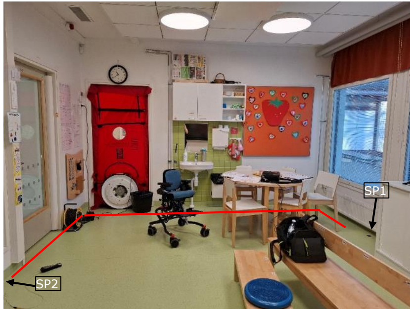
Kuva 40. Merkkiainekaasu ei levinnyt alapohjarakenteessa syöttöpisteeseen SP2, mutta se levisi väliseiniä pitkin muovimaton ylösnostoon molemmille väliseinille.
