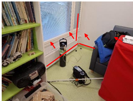
Kuvat 28 ja 29. Syöttöpisteiden SP1 vuotokohdat Mansikoiden pienryhmähuoneessa 171 ja sen vastaisessa tilassa 174 merkittynä kuvaan punaisella viivalla (merkittävä vuoto) ja punaisella nuolella (pistemäinen vuoto).
