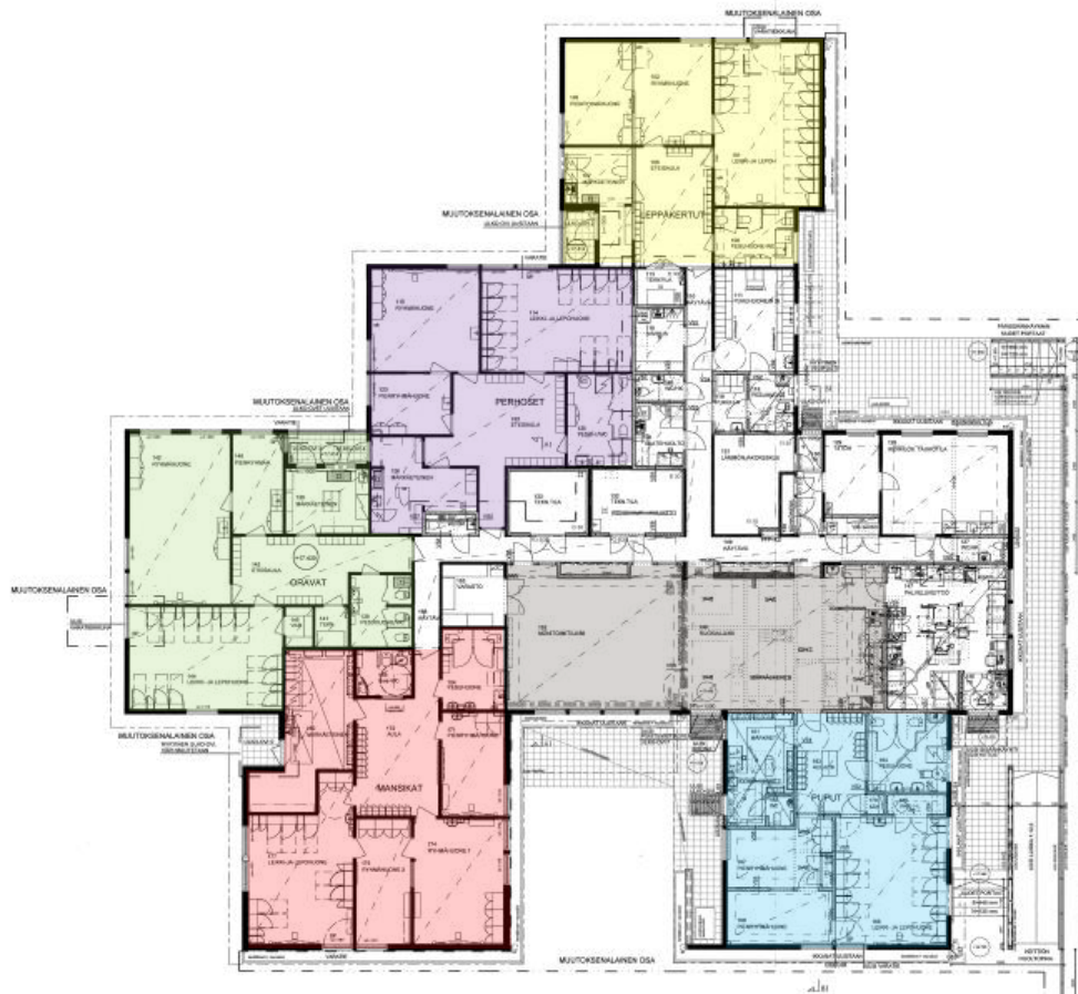
Kuva 2. Päiväkoti jakautuu osasto- ja toimistotiloihin sekä keskiosalla yhteiskäytössä oleviin ruokailu- ja liikuntatiloihin. Päiväkodin keittiö sijaitsee Kallelankadun varrella. Kuvassa henkilökunnan sosiaalitilat, kiinteistö- ja laitoshuoltotilat, toimistot ja keittiö on esitetty valkoisella, yhteiskäytössä olevat tilat (jumppasali, ruokasali) harmaalla ja päiväkotiosastot seuraavasti: Mansikat = punainen, Oravat = vihreä, Perhoset = liila, Leppäkertut = keltainen, Puput = sininen.
