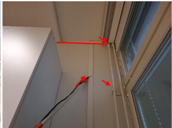
Kuva 67 ja 68. Syöttöpisteen SP1 vuotokohdat perhosten huoneessa 114 merkittynä kuvaan punaisella viivalla (merkittävä vuoto) ja punaisella nuolella (pistemäinen vuoto).
