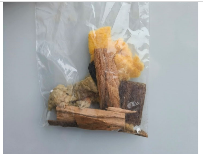
Kuva 5. Alapohjan täytöstä kerättyä rakennusjätettä. Haisevasta puumateriaalista otettiin kloorifenolinäyte (KF1). Näytteessä ei esiintynyt kloorifenoleja.
