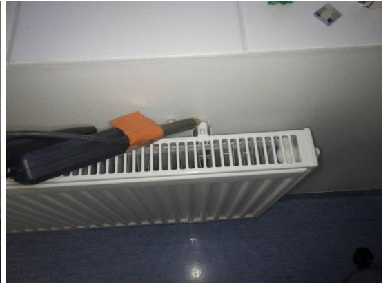
Kuvat 139 ja 140. Välipohjan merkkiainekoe MA1 opettajanhuoneessa 101. Merkkiaine kulkeutuu välipohjan eristetilasta ulkoseinien lisäeristekerrokseen ja virtaa huonetilaan ikkunapenkin reunalta, huoneen nurkassa olevasta levykoteloinnista ja ulkoseinän patterikannakkeista.
