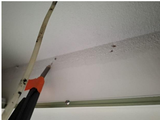
Kuvat 327 ja 328. Yläpohjan merkkiainekoe MA15 huoneessa 121. Alakattotilaan kulkeutuu yläpohjasta peräisin olevaa ilmavuotoa ulkoseinän yläosassa olevista käytöstä poistetuista kiinnityskohdista ja huoneen nurkassa olevasta sähköjohtojen läpiviennistä.
