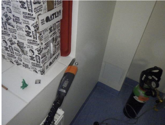
Kuvat 139 ja 140. Välipohjan merkkiainekoe MA1 opettajanhuoneessa 101. Merkkiaine kulkeutuu välipohjan eristetilasta ulkoseinien lisäeristekerrokseen ja virtaa huonetilaan ikkunapenkin reunalta, huoneen nurkassa olevasta levykoteloinnista ja ulkoseinän patterikannakkeista.
