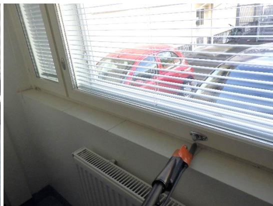
Kuvat 202 ja 203. Ulkoseinän merkkiainekoe MA12 toimistotilassa 121. Kivirakenteisen ulkoseinän eristetilaan sisäkautta syötettyä merkkiainetta havaittiin pistemäisesti lattialiittymässä ja ikkunan alaliittymässä.
