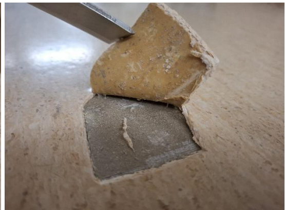
Kuvat 74 ja 75. Puutyöluokan varaston 036 viiltomittauksessa V3 ja vertailumittauksessa V4 suhteellinen kosteus oli koholla lattiapäällysteen alla. Viillossa V3 liima oli tummentunut. Molemmissa viilloissa havaittiin poikkeavaa kemiallista hajua.
