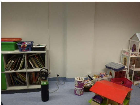
Kuvat 274 ja 275. Väliseinän merkkiainekoe MA24 huonetilassa 138. Väliseinän alareunaan syötetty kaasu kulkee huoneeseen alakaton takana olevasta yläpohjaliittymästä. Vuoto on erittäin runsasta.
