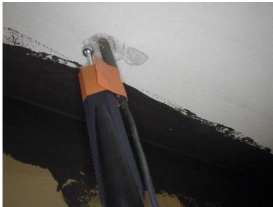
Kuvat 324 ja 325. Yläpohjan merkkiainekoe MA11 luokassa 201. Yläpohjan betonipinnalla olevista vanhoista ja uusista kannakointikohdista virtaa runsaasti ilmaa huonetilan suuntaan. Ulkoseinän sisäverhouslevy on tiivistetty yläpohjaan ilmatiivistystuotteella.
