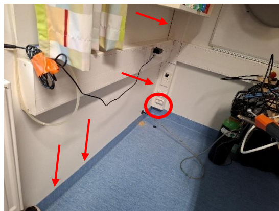
Kuvat 206 ja 207. Ulkoseinän merkkiainekoe MA20 luokassa 122. Kivirakenteisen ulkoseinän eristetilaa sisäkautta syötettyä merkkiainetta havaittiin ulkoseinänurkassa olevan sähkökotelon alareunasta ja liittymistä sekä ikkunan alaliittymästä ja seinällä olevissa patterikannakkeissa.
