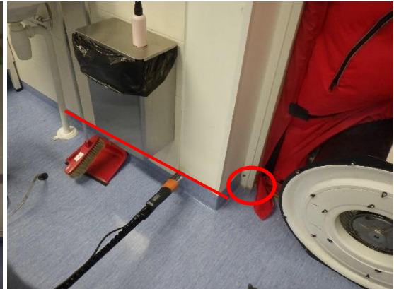
Kuvat 144 ja 145. Merkkiainekokeet MA16 ja MA18 luokassa 109. Kellaritilaan syötettyä merkkiainetta kulkeutuu huoneeseen nurkassa olevasta levykoteloinnin reunoilta ja sisältä sekä ulko- ja väliseinillä olevista sähkölistoista. Eristetilaan syötetty merkkiaine virtaa huonetilaan lattialiittymistä, matonkäänteiden reunoilta sekä ovikynnyksen reunoilta.
