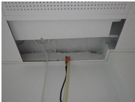
Kuvat 274 ja 275. Väliseinän merkkiainekoe MA24 huonetilassa 138. Väliseinän alareunaan syötetty kaasu kulkee huoneeseen alakaton takana olevasta yläpohjaliittymästä. Vuoto on erittäin runsasta.
