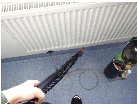
Kuvat 202 ja 203. Ulkoseinän merkkiainekoe MA12 toimistotilassa 121. Kivirakenteisen ulkoseinän eristetilaan sisäkautta syötettyä merkkiainetta havaittiin pistemäisesti lattialiittymässä ja ikkunan alaliittymässä.
