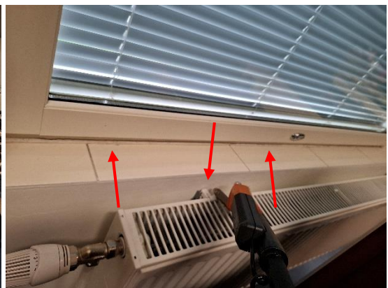
Kuvat 206 ja 207. Ulkoseinän merkkiainekoe MA20 luokassa 122. Kivirakenteisen ulkoseinän eristetilaa sisäkautta syötettyä merkkiainetta havaittiin ulkoseinänurkassa olevan sähkökotelon alareunasta ja liittymistä sekä ikkunan alaliittymästä ja seinällä olevissa patterikannakkeissa.
