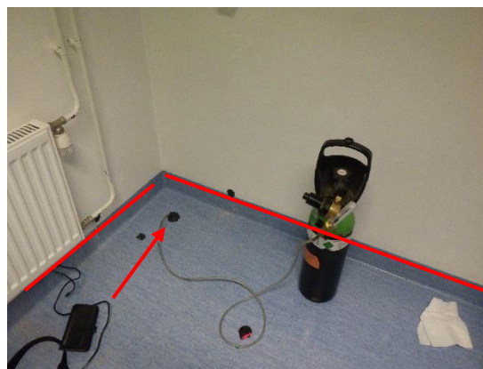
Kuvat 90 ja 91. Merkkiainekoe MA22 iltapäiväkerhon huonetilassa 142. Alapohjan eristetilaan syöttöpisteiden SP1 ja SP2 kautta syötettyä merkkiainetta havaittiin laajasti lattialiittymissä, matonkäänteen reunalta. Päästö on laaja ja voimakas. Vuotokohdat on merkattu kuviin punaisilla viivoilla ja syöttöpiste SP1 punaisella nuolella.
