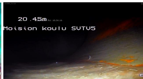
Kuvat 379 ja 380. Vasemmalla kuva SVTV3 linjan pohjalla olevasta likakertymästä. Oikealla kuva SVTV5 esimerkkipiirros linjan aaltoilusta (kuvassa maltillinen).
