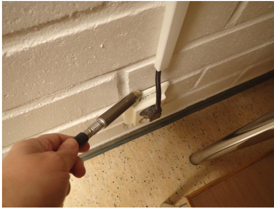
Kuvat 29 ja 30. Vuotokohtia havaittiin ulkoseinällä olevien kiinnitysten kohdilla, kuten pistorasiasta. Lisäksi vuotoa havaittiin pistemäisesti sisäverhouksen muurauksen tiilisaumojen läpi paikallisesti.
