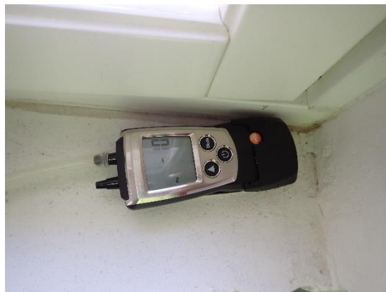
Kuvat 35 ja 36. Koejärjestelyt, merkkiainekoe MA2. Kuvassa 35 kaasun syöttöpiste. Alipaineistus toteutettiin samalla menetelmällä kuin merkkiainekokeessa MA1. Käytävätilan 103 alipaine oli tutkimushetkellä noin 10 Pa ulkovaipan yli.
