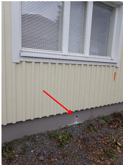
Kuvat 25 ja 26. Koejärjestelyt, alapohjan merkkiainekoe MA1 tilassa 132. Kuvassa 25 merkitty kaasu-syöttökohta ja kuvassa 26 alipaineistuslaitteet tuulikaapin ovella.
