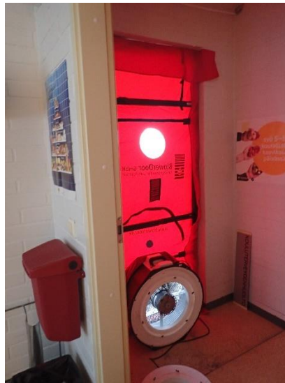
Kuvat 25 ja 26. Koejärjestelyt, alapohjan merkkiainekoe MA1 tilassa 132. Kuvassa 25 merkitty kaasu-syöttökohta ja kuvassa 26 alipaineistuslaitteet tuulikaapin ovella.
