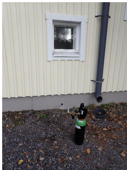
Kuvat 35 ja 36. Koejärjestelyt, merkkiainekoe MA2. Kuvassa 35 kaasun syöttöpiste. Alipaineistus toteutettiin samalla menetelmällä kuin merkkiainekokeessa MA1. Käytävätilan 103 alipaine oli tutkimushetkellä noin 10 Pa ulkovaipan yli.
