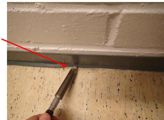
Kuvat 27 ja 28. Vuotokohtia havaittiin paikoissa, joissa jalkalista ei ole muovimaton päällä tiiviisti (maton reuna ei ulotu seinälle saakka) sekä jalkalistan päältä kohdista, joissa jalkalista ei ollut tiiviisti kiinni seinäpinnassa, erityisesti tiilimuurauksen saumojen kohdilla.
