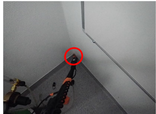
Kuvat 184 ja 185. Opetustilan 128 ikkunaseinän patterin tulo- ja paluulinjojen läpiviennistä. Ikkunaseinän vasemmasta ja oikeasta kulmasta muovimaton ylösnoston kohdalta ja laajemmin muovimaton ylösnoston alta muovimattoja raottamalla.
