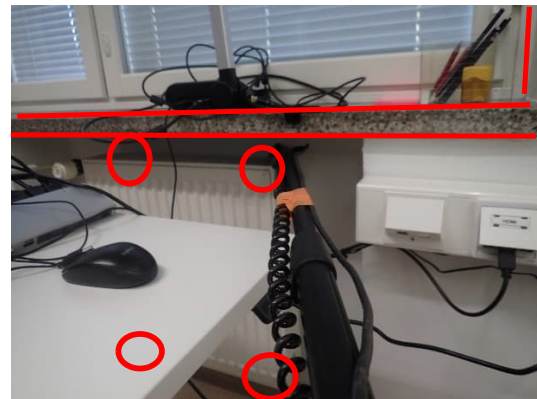
Kuvat 253 ja 254. Kuraattorin huoneen päätyseinän pistemäisiä merkittäviä vuotopaikkoja on havainnollistettu punaisilla ympyröillä ja jatkuvia vuotopaikkoja yhtenäisillä viivoilla. Oranssilla nuolella on esitetty vähäinen vuotokohta lattaraudan kohdalta. Kaasun syöttöpiste on merkitty sinisellä nuolella.
