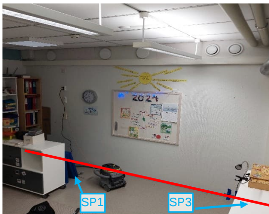
Kuva 43 ja 44. Ryhmähuoneen B205b alapohjan merkkiainekokeen MA1 havaitut ilmavuotopaikat on merkitty punaisilla viivoilla. Vuotopaikkoja todettiin kattavasti väliseinän ja ulkoseinän alapohjaliittymästä. Kaasun syöttöpisteet (SP) on merkitty sinisillä nuolilla.
