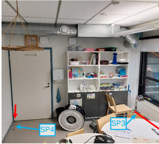
Kuva 46 ja 47. Ryhmähuoneen B105a alapohjan merkkiainekokeessa MA2 havaitut ilmapuotopaikat on merkitty punaisilla nuolilla ja jatkuvat vuodot punaisella viivalla. Kaasun syöttöpisteet (SP) on merkitty sinisillä nuolilla.
