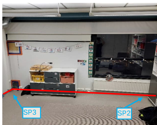
Kuva 43 ja 44. Ryhmähuoneen B205b alapohjan merkkiainekokeen MA1 havaitut ilmavuotopaikat on merkitty punaisilla viivoilla. Vuotopaikkoja todettiin kattavasti väliseinän ja ulkoseinän alapohjaliittymästä. Kaasun syöttöpisteet (SP) on merkitty sinisillä nuolilla.
