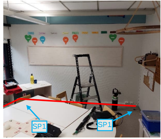
Kuva 46 ja 47. Ryhmähuoneen B105a alapohjan merkkiainekokeessa MA2 havaitut ilmapuotopaikat on merkitty punaisilla nuolilla ja jatkuvat vuodot punaisella viivalla. Kaasun syöttöpisteet (SP) on merkitty sinisillä nuolilla.
