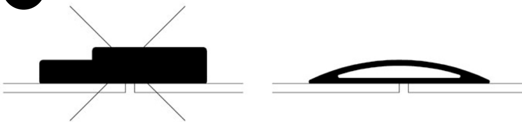
Bild 13k Exempel på en tillgänglig flexibel tröskel. (Invalidförbundet)
