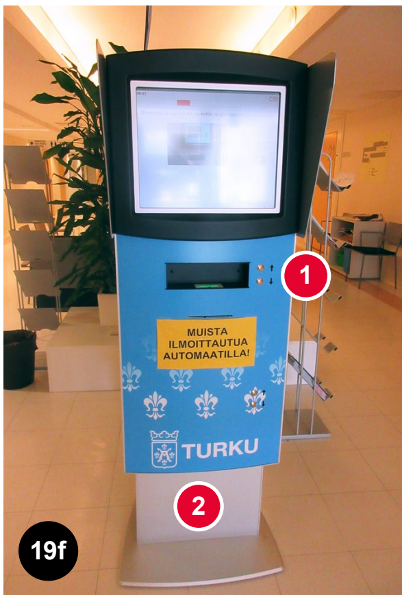
Bild 19f Hyvä ratkaisu: Ilmoittautumisautomaatin korkeus on helposti säädettävissä [1,2] eri korkeuksilla olevista säätöpainikkeista. (Keskushammashoitola, Turku)
