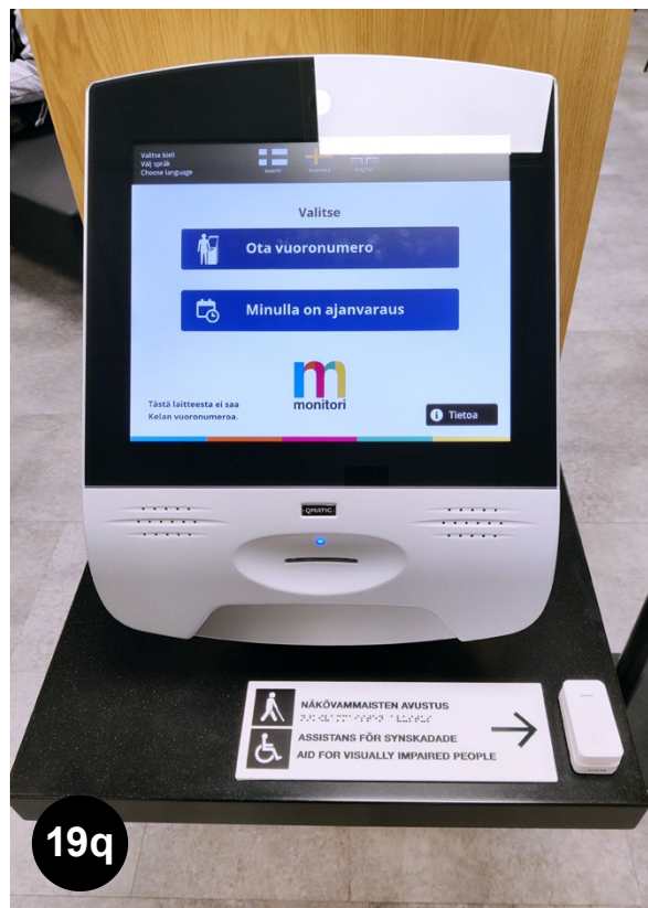
Bild 19q En bra lösning: I anslutning till könummeranordningen finns också en hjälpknapp för synskadade. (Salutorgets Monitori, Åbo stad, Åbo)
