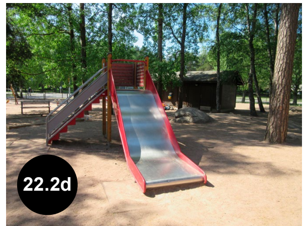
Bild 22.2d En bra lösning: Rutschbanan är 100 cm bred, varvid assistenten kan rutscha med barnet. (Isoisten- Petreliuksen päivähöito, Åbo)
