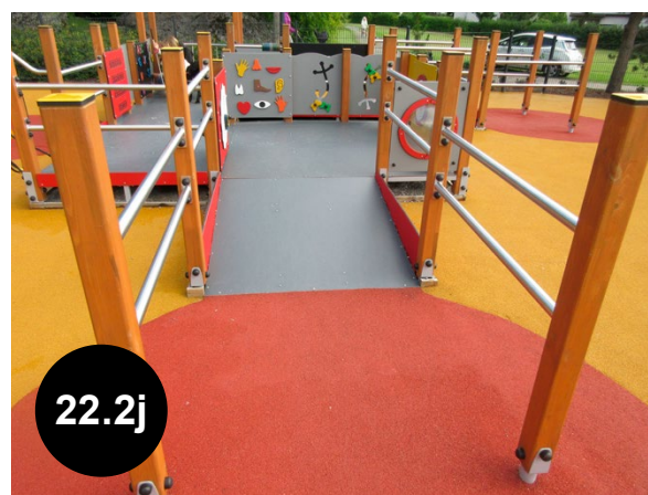
Bild 22.2j En bra lösning: På lekplatsen finns ett lekområde, dit man även kan ta sig med rullstol längs rampen. Detta lekområde har färggranna delar med stora kontraster som man kan känna på. (Uittamo tillgängliga lekplats, Åbo)
