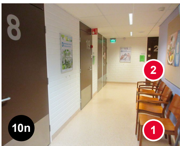
Bild 10n En bra lösning: [1] På förbindelseleden finns flera sittplatser med ryggstöd och [2] på en del sittplatserna finns också armstöd som underlättar uppstigningen. (Tallbackens hälsostation, Åbo)
