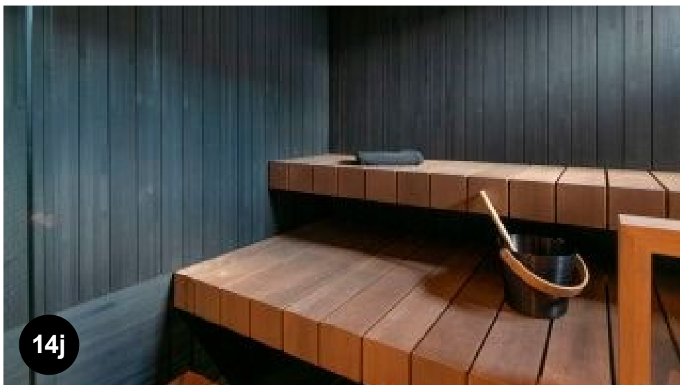
Bild 14j En tillgänglig bastu kan också vara elegant genomförd och färgkontrasterna fungerar bra. En dålig lösning: Ledstänger saknas. (Bostadsmässan 2020, Objekt 38 Hetena, Saunalogia.fi)
