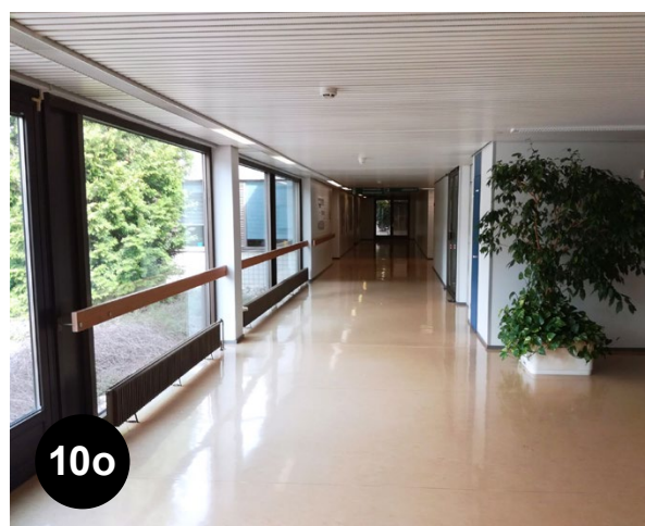
Bild 10o En dålig lösning: Reflektionerna på förbindelseledens golv gör det svårare att gestalta den. Dessutom har korridoren dålig belysning. (Handikappservice, Åbo)
