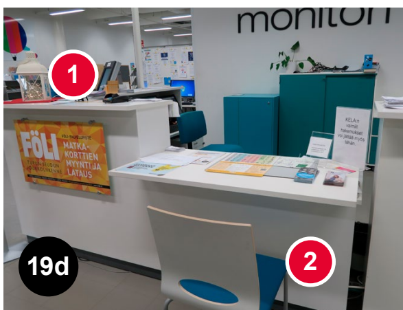
Bild 19d En bra lösning: Vid servicedisken kan man uträtta ärenden både [1] stående och [2] sittande. (Skanssis Monitori, Åbo)
